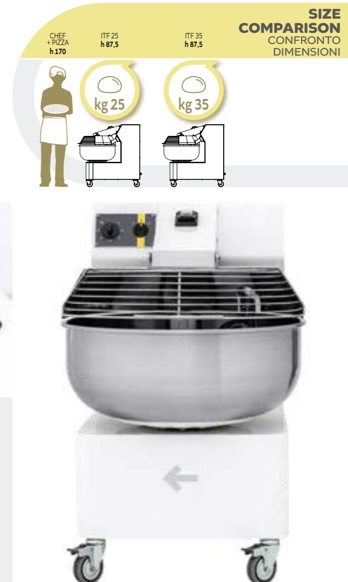
Les pétrins à fourche Ottimade permettent d'obtenir des pâtes parfaitement mélangées et rapidement. Appareil idéal pour les professionnels de la pizza, de la pâtisserie et de la boulangerie, les pétrins à fourche sont équipés d'une cuve, d'un arbre de transmission et d'une fourche en acier inox AISI 304. Système de transmission avec motoréducteur à bain d'huile.
